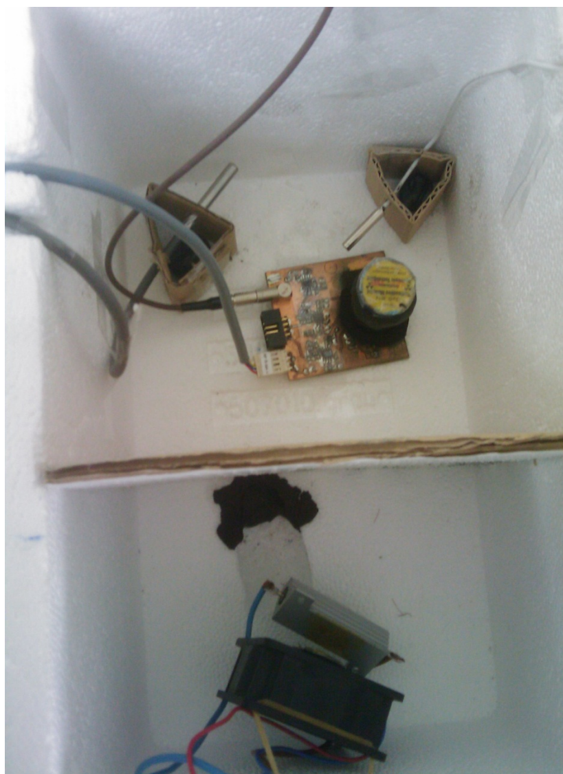
Figura 3: Set-up de la caracterización del SiPM. Zona inferior, la zona turbulenta con el foco caliente (resistencia cementada + ventilador), separada de la Zona Homogénea por el filtro: Sondas AKO y TA20, muestra de Cesio-137 sobre un cristal LYSO que descansa sobre el detector S10362-11-050U/C; el conjunto centelleador + SiPM cubierto por un material opaco pues la luz visible genera pares de portadores en el detector.
